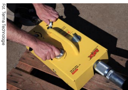
Stacja sterująca. Zmiana kierunku pracy następuje przez przestawienie dźwigni na olejacz
